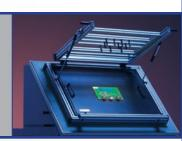
Im Niederhaltesystem können die Niederhaltepunkte in x / y Richtung manuell verschoben, und so für jeden Prüfling eingerichtet werden. Natürlich ist es möglich, Niederhalteplatten mit prüflingsspezifischen Niederhaltepunkten sehr schnell aus- und einzuwechseln. Ein zeitraubendes Einstellen der x / y - Positionen für den Prüfling entfällt.
